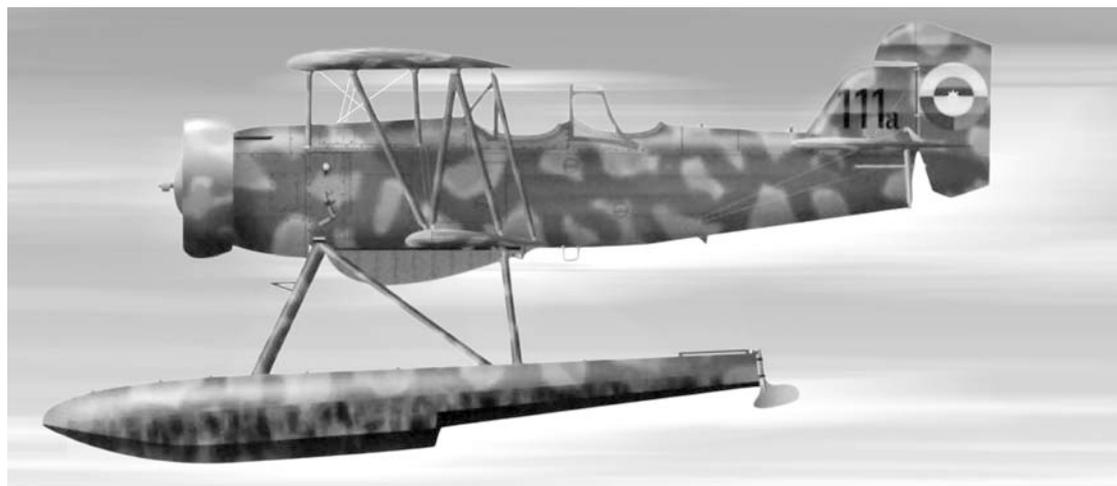
*Curtiss Falcon F-8F con mimetismo selvático y flotadores, completamente adaptado para operar y combatir sobre las selvas y ríos del sur del país. Esta aeronave tenía un alcance de 630 millas náuticas a una velocidad de crucero de 130 nudos, una tripulación de 3 hombres, e iba armado con dos ametralladoras .30*
